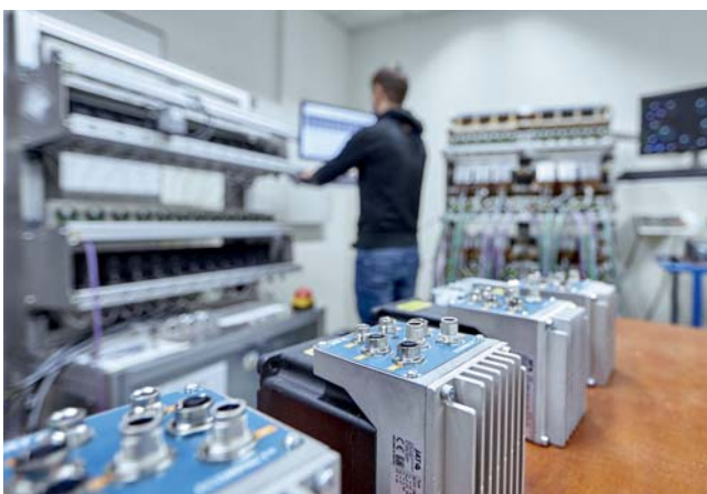
Funktionstest des JAT Servokompaktantriebs ECOMPACT® E100
